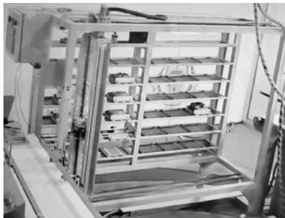
Figura 3. Estación para administración de inventarios y suministro de materia prima AS/RS. Fuente: (Pulloquina, 2014)
