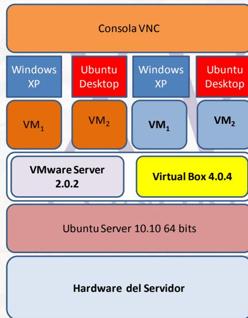
**Figura 3.** Abstracción del esquema de distribución de elementos por capas en el servidor
