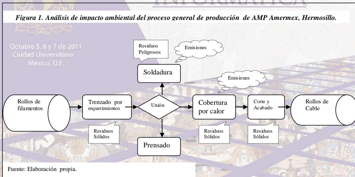
El proceso general de producción de la maquiladora AMP tiene tres procesos básicos; el trenzado, la unión y el recubrimiento. Algunos cables son prensados y otros soldados, el tipo de cables de mayor impacto al ambiente son los de soldadura de estaño que produce emisiones de monóxido de carbono, aceites residuales y partículas sólidas de estaño. La cobertura por calor produce también monóxido de carbono al aire ambiente laboral y utiliza químicos inflamables y
