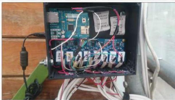
*Ilustración 1: Microcontrolador para la capa tres, Arduino Yún, el cual nos permite la conexión a Internet necesaria para la capa cuatro.*
